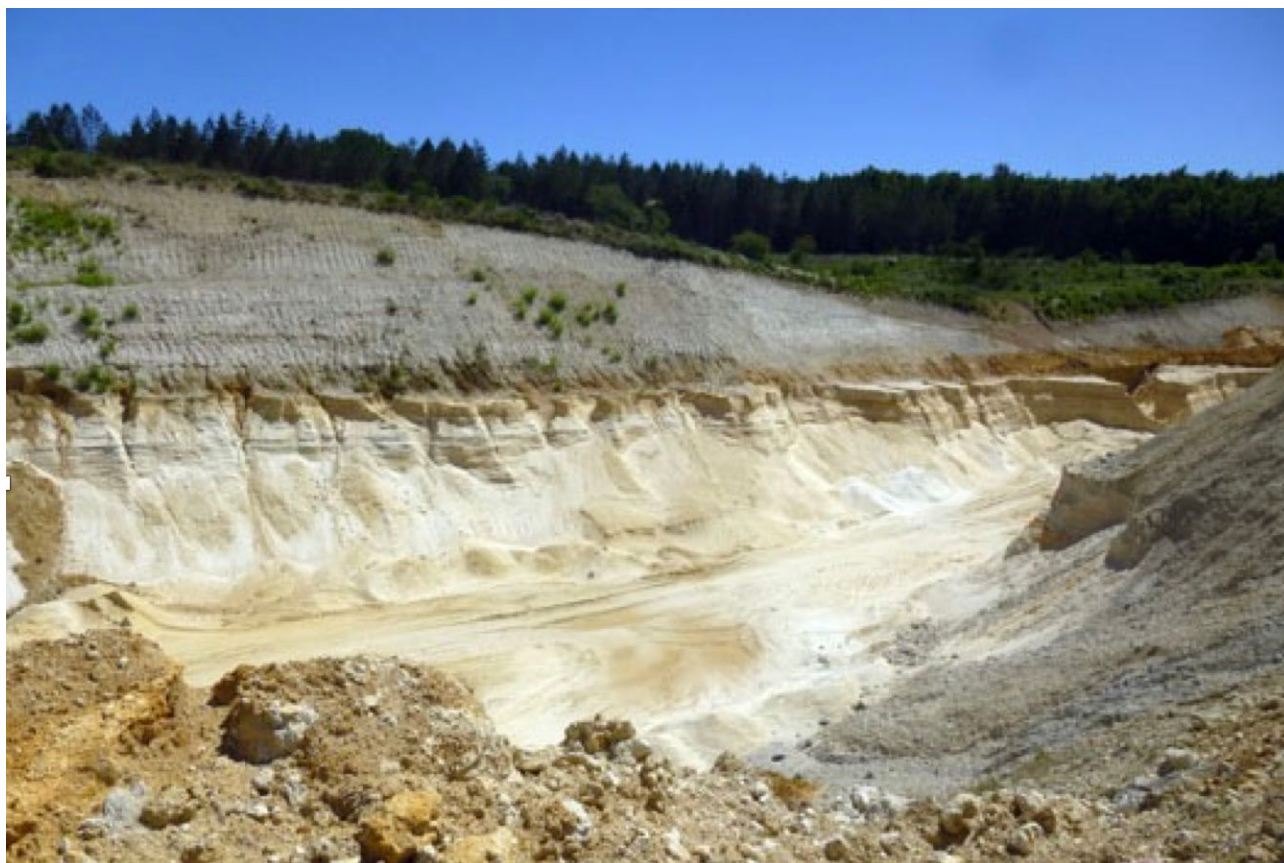
Fig. 1 – Carrière de Combiers. Aperçu du front de taille de la sablière (été 2022). De bas en haut : 1. Santonien : sables blancs du Santonien exploités pour de l’optique ; 2. Cordon ferrugineux qui marque la limite entre le Santonien et le Campanien ; 3. Campanien : calcaire crayo-marneux, puis calcaire crayeux en voie de disparition. Au premier plan des déblais Campanien. © Dominique Deschamps.
